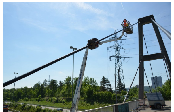
Magnetinduktive Prüfung der Schrägkabel
